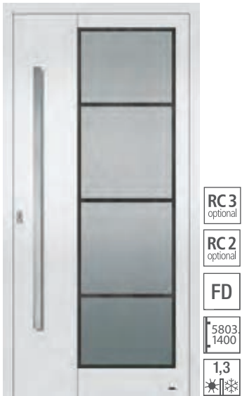
5508 geteilte Sprossen 90 mm, 365 mm breiter Applikation außen aufgebracht, Wärmeschutzisoliertglas, vorne: VSG mattiert mit klarem Rand und Streifen; hinten: Float beschichtet; Oberfläche: RAL 9016 weiß
