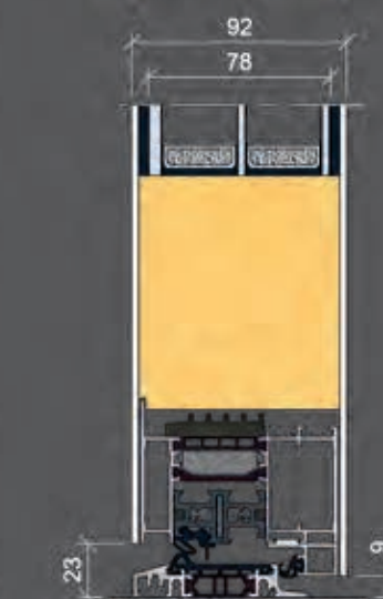
Ausführung mit schrägem Blendrahmen (optional): KÖSTER ADVANCE 108
