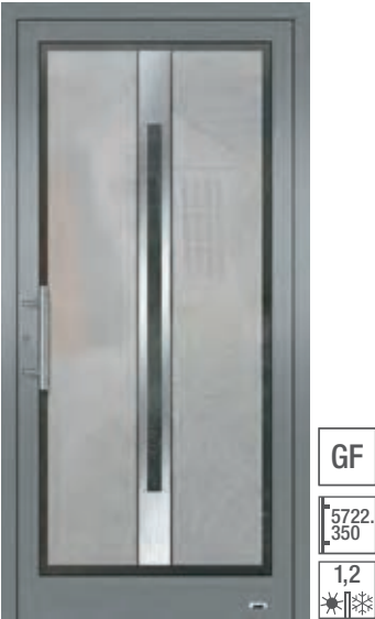
5459 Wärmeschutzisoliertglas, vorne: VSG beschich- tet, Mitte: ESG mattiert mit klarem Rand und Streifen in der NIRO-Applikation, hinten: ESG. Oberfl: Sparkling Iron FSM
