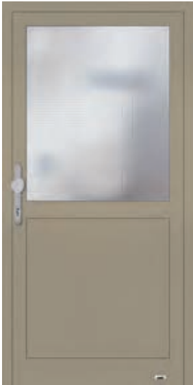
5506-2 ADVANCE 75 mit 100 mm Glasleistensprosse, Verglasung: Wärmeschutzisoliertes Glas vorne VSG beschichtet, hinten: Mastercarre, al- ternativ: Float oder Chinchilla weiß, unten wärmegeädämmtes; Alu-Sandwich-Paneel, 30 mm stark. Oberfläche: Beige FSM
