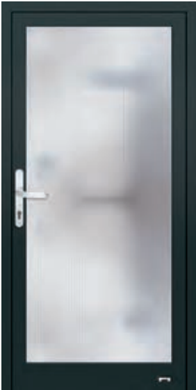
5510 ADVANCE 75 Verglasung: Wärmeschutzisoliertes Glas, vorne: VSG beschichtet, hinten: Mastercarre, alternativ: Float oder Chinchilla weiß. Oberfläche: ca. RAL 7016 Nightgrey FS , beidseitig Drücker 5881 aus Aluminium in weiß oder silberfarbig.
