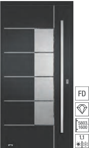
5332 Stoßgriff auf Füllung montiert, vorne: VSG mattiert mit klaren Streifen, hinten: Float beschichtet, Lisenen in NIRO-Design nicht flächenbündig, Oberfläche: DB 703 FSM
